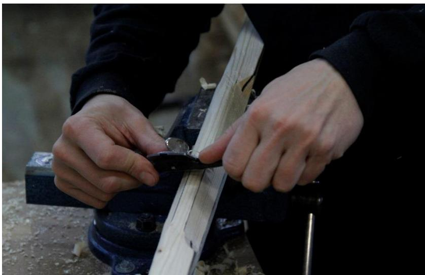
Du har nå høvlet åren ferdig og turen kommer til pussing og finish. Først og fremst må åren pusses grundig. Man tenker kanskje at overflatebehandling vil dekke over slett pussearbeid, men det forholder seg ofte
