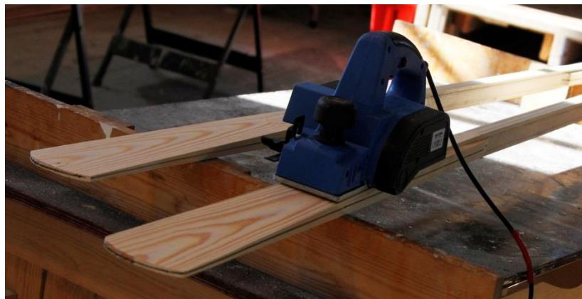
8 mm. tykk. Med utgangspunktet som er 23 skal du altså i alt høvle 7-8 mm. ned på hver side av emnet ytterst. Du har nå høvet årebladet ned til ferdig tykkelse. Du tegner nå en tusj strek langs midten av årebladet, fra slutten av skaftet og helt ut.
