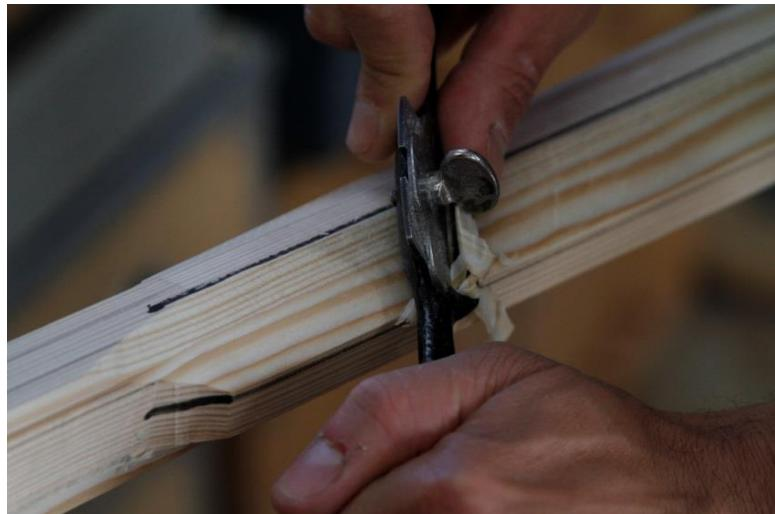
Etter hødling av åreblad kommer turen til skaftet. Du bruker igjen skavhøvl og høvler bort materialet mellom strekene på skaftets kanter. På den måten oppnår du en perfekt åtte-kant – åtte flater med vinkler på 135 grader. Etter dette høvler du på fri hånd (uten streker) kantene som gjenstår, til du oppnår en jevn oval form.
