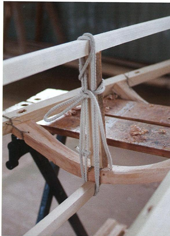
❶ **LETT KONSTRUKSJON.** Skjelettet dekkes med seilduk, som behandles flere ganger med en spesiell oljemaling som gjør den vanntett.
